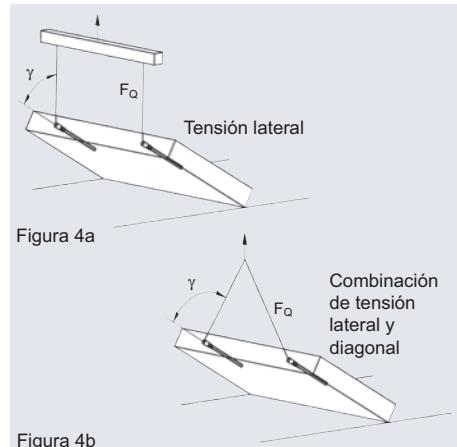
La Tabla 5 da al usuario la posibilidad de utilizar una varilla de refuerzo de anclaje (Figura 5c) o una varilla de refuerzo doble (Figura 5a) para la tensión lateral. Estas varillas deben estar en contacto con el casquillo roscado. La carga lateral con los **anclajes de elevación PHILIPP** sólo es admisible con espesores iguales o superiores a los indicados en la Tabla 3.
