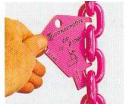
Comprobación del alargamiento del paso del eslabón por desgaste del diámetro nominal.
