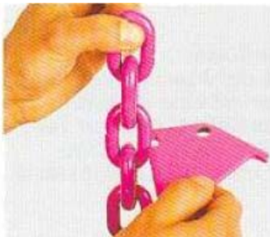
Comprobación del desgaste del Diámetro nominal del eslabón.
