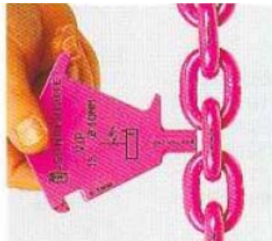
Comprobación del alargamiento plástico del eslabón por sobrecarga.
