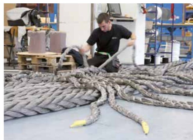
Da geht noch mehr: Sonderanfertigung einer Megaschlinge mit 900t WLL Beyond the limits: a megasling with 900t WLL being custom-made
